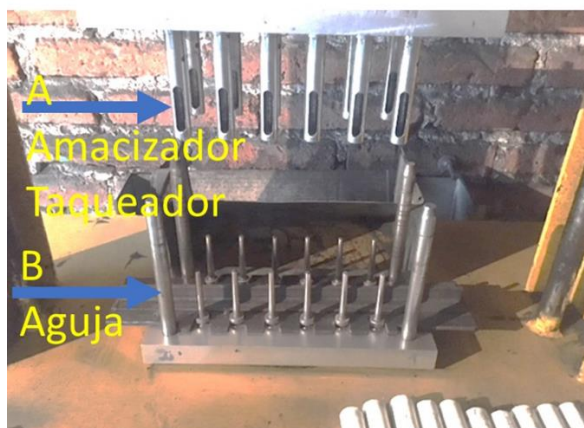
Fig. 2. Piezas que sufren desgaste por fricción.
